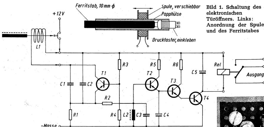
Bild 1. Schaltung des elektronischen Türöffners. Links: Anordnung der Spule und des Ferritstabes
