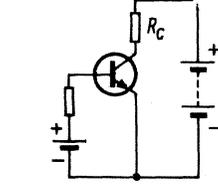
Bild 11. Erzeugen der Basisspannung durch eine Batterie
