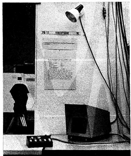
Bild 5. Fernsehtelefon Videophone. Vidicon-Kamera und Lautsprecher sind im Bildröhrengehäuse untergebracht, das Mikrophon steckt im Bedienungskästchen links. Diese Aufnahme zeigt den typischen Aufbau aller ausgestellten 110 Forschungsarbeiten
