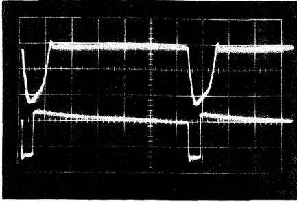
Bild 3. Triggersignal vom Zeilentransformator für den Sperrschwinger, 200 V/cm und 10  $\mu$ s/cm (oben). Steuersignal vom Sperrschwinger für die Ansteuerung der Schalter, 5 V/cm und 10  $\mu$ s/cm (unten)
