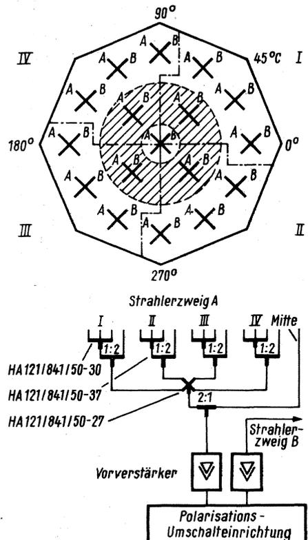
Bild 5. Schematische Darstellung der VHF-Empfangsantenne gemäß Bild 4. Bei Programmsteuerbetrieb sind alle 17 Kreuzdipole eingeschaltet. Die innere Antenne wird über den Zweifachhauptverteiler HA 121/841/50-37, die mittleren Strahler über den Vierfachverteiler HA 121/841/50-27 und den Zweifachverteiler HA 121/841/50-30 gespeist und die äußeren Strahler über den Vierfach- und den Dreifachverteiler HA 121/841/50-30. Daraus ergeben sich die angestrebten Amplitudenverhältnisse  $1 : 0,58 : 0,24$
