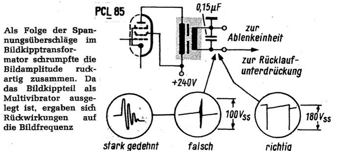
Als Folge der Spannungsüberschläge im Bildkipptransformator schrumpfte die Bildamplitude ruckartig zusammen. Da das Bildkippteil als Multivibrator ausgelegt ist, ergaben sich Rückwirkungen auf die Bildfrequenz
