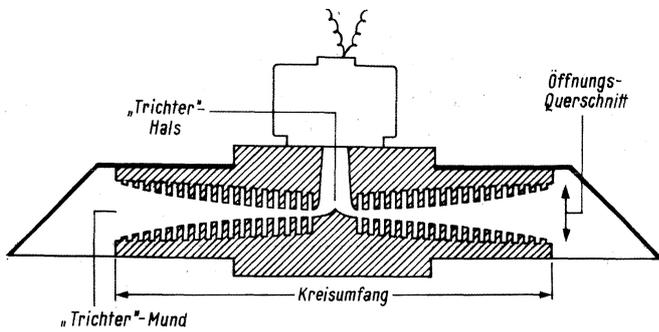
Bild 1. Querschnittsskizze eines neuartigen, sehr kleinen Hornlautsprechers
