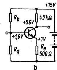
Bild 14. Verstärkerstufen mit Germanium-pnp-Transistor (a) und Silizium-npn-Transistor (b)
