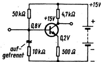
Bild 18. Spannungen an den Elektroden bei unterbrochener Kollektor-Basis-Strecke
