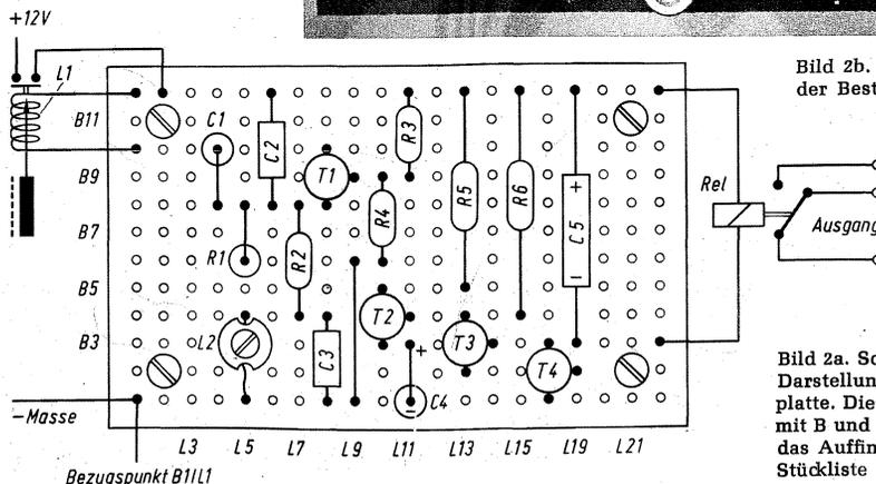
Bild 2a. Schematische Darstellung der Leiterplatte. Die Zahlenreihen mit B und L erleichtern das Auffinden in der Stückliste
