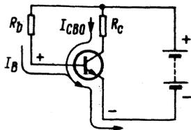
Bild 10. Wirkung von  $I_{CBO}$  auf  $I_B$
