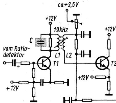
Der fehlerhafte Kondensator C verhinderte die Ausbiegung des Pilottones. Daher lieferte der Decoder auch bei Stereosendungen nur ein monofones Signal
