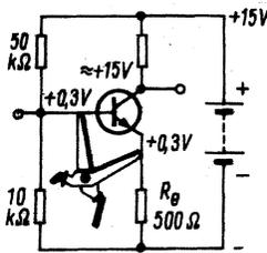
Bild 15. Prüfung der Steuerwirkung
