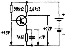
Bild 8. Potential an der Kollektordiode
