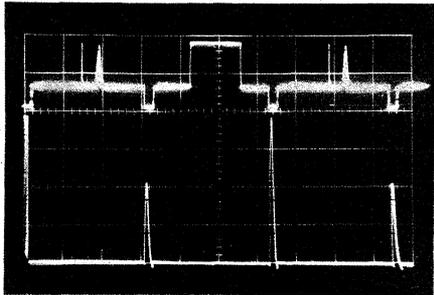
Bild 4. Prüfzeilen am Ausgang des Videotransformators, 0,5 V/cm und 20  $\mu$ s/cm (oben). Spannung am Kollektor der Schaltertransistoren, 10 V/cm und 20  $\mu$ s/cm (unten)
