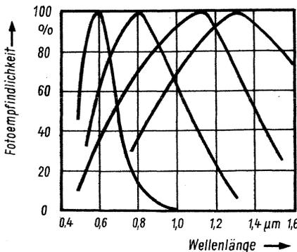
Kurven von Chalkogenid-Gläsern unterschiedlicher Zusammensetzung. Durch Wahl der Glas-sorte läßt sich die maximale Fotoempfindlichkeit für bestimmte Längenwellenbereiche erzielen
